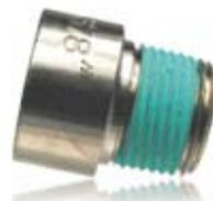
La technique consiste à pré-enduire les filetages avec une colle micro-encapsulée qui s'active uniquement lors du montage. Lors de l'assemblage, l'adhésif libéré par l'éclatement des micro-capsules se mélange au durcisseur et colle les éléments filetés entre eux.
